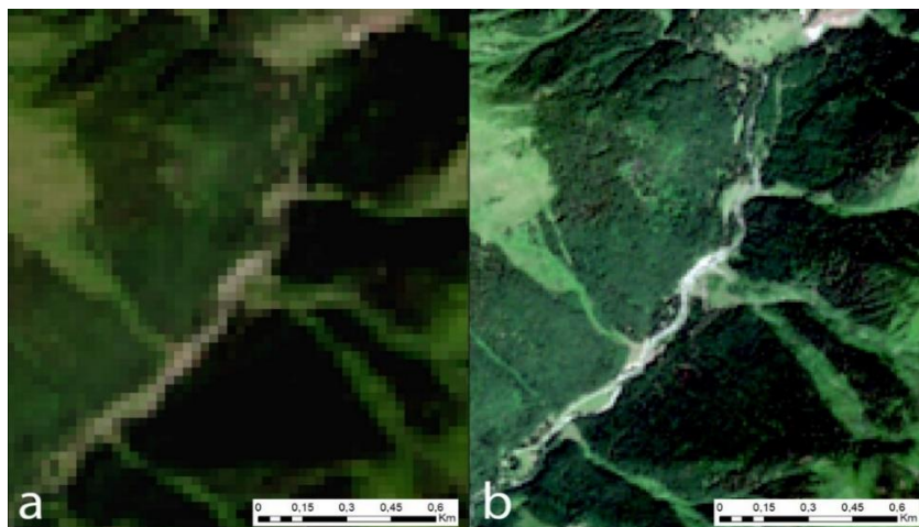
Figura 2 Comparație între un compozit color Landsat 8 (a) și un compozit Sentinel 2 (b)
